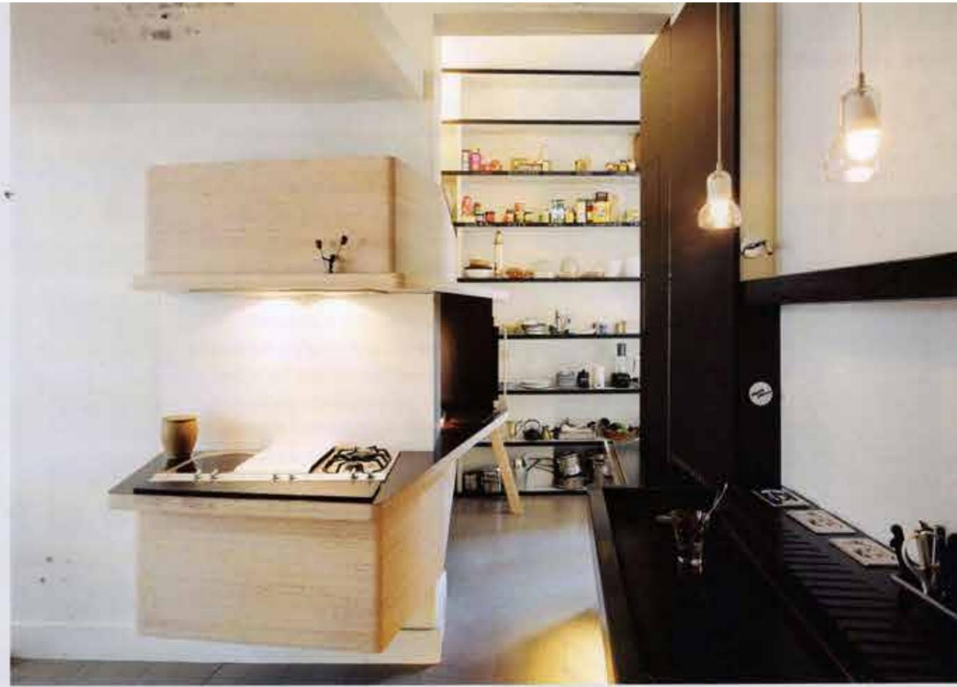
Afin de relier la cuisine et le cellier, le meuble «feu», composé de trois plaques et d'un four, s'enroule autour du mur. L'habillage des bandeaux du meuble cuisson a été obtenu par la superposition de panneaux de multiplis.
